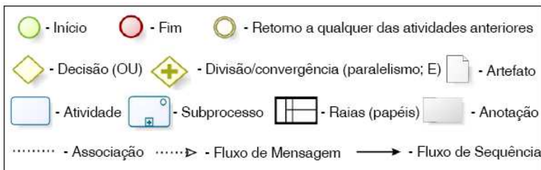
Figura 3: Breve descrição dos elementos básicos da notação BPMN
