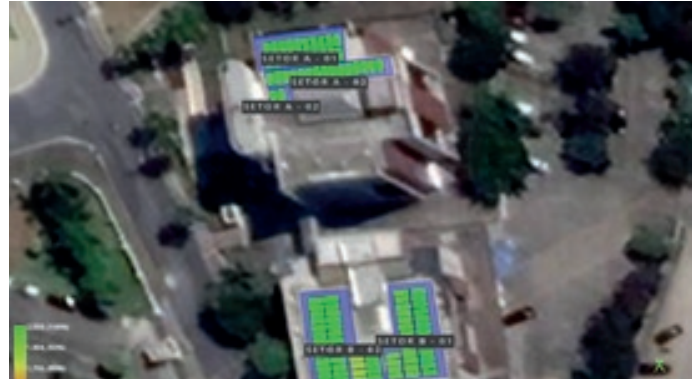
Disposição dos módulos fotovoltaicos no FIJ.
